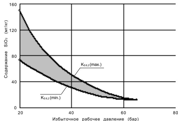
\*Зависимость допустимого содержания SiO<sub>2</sub> от рабочего избыточного давления и щелочности
